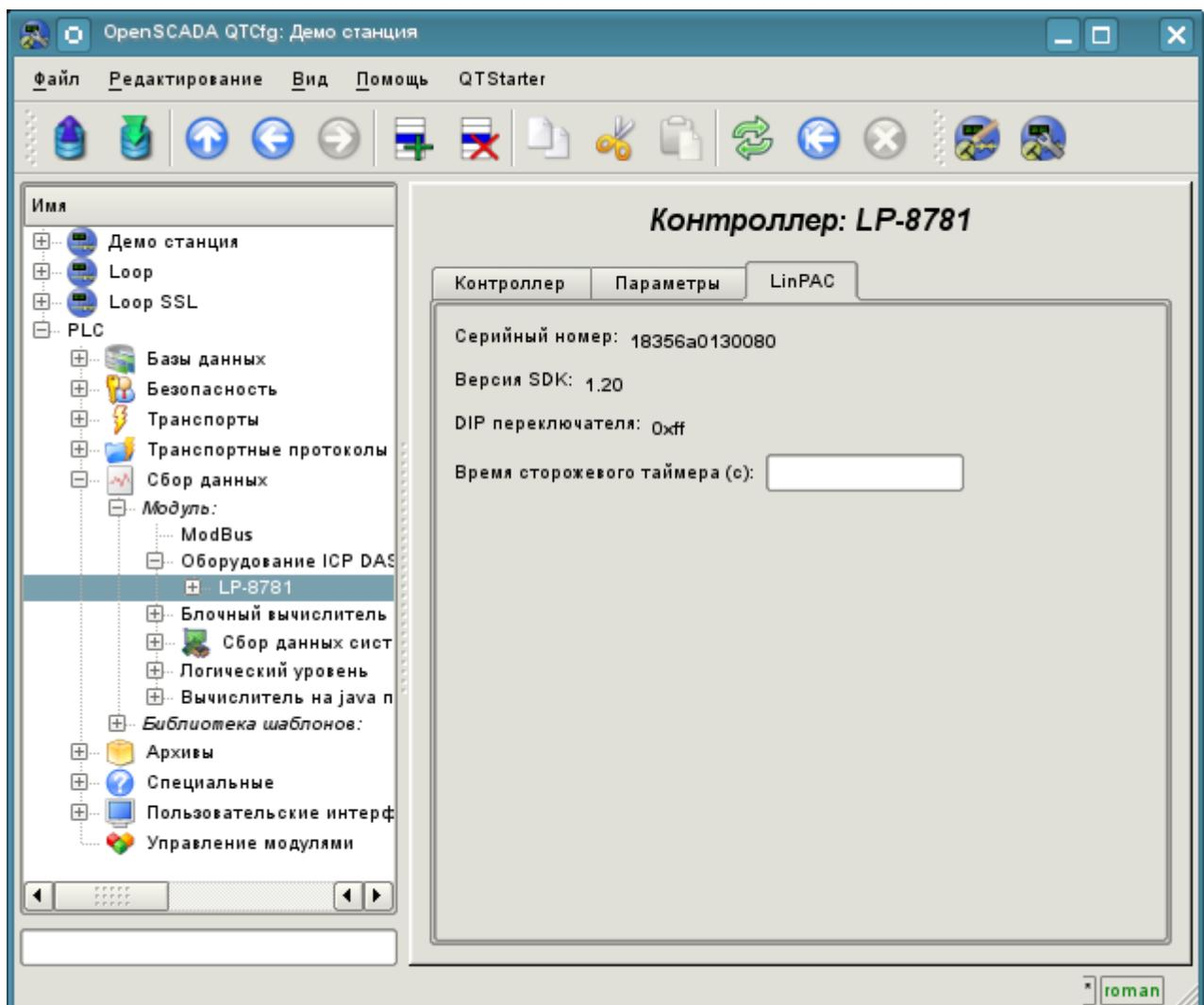
Рис.7. Вкладка конфигурации контроллеров серии LP-8x81
