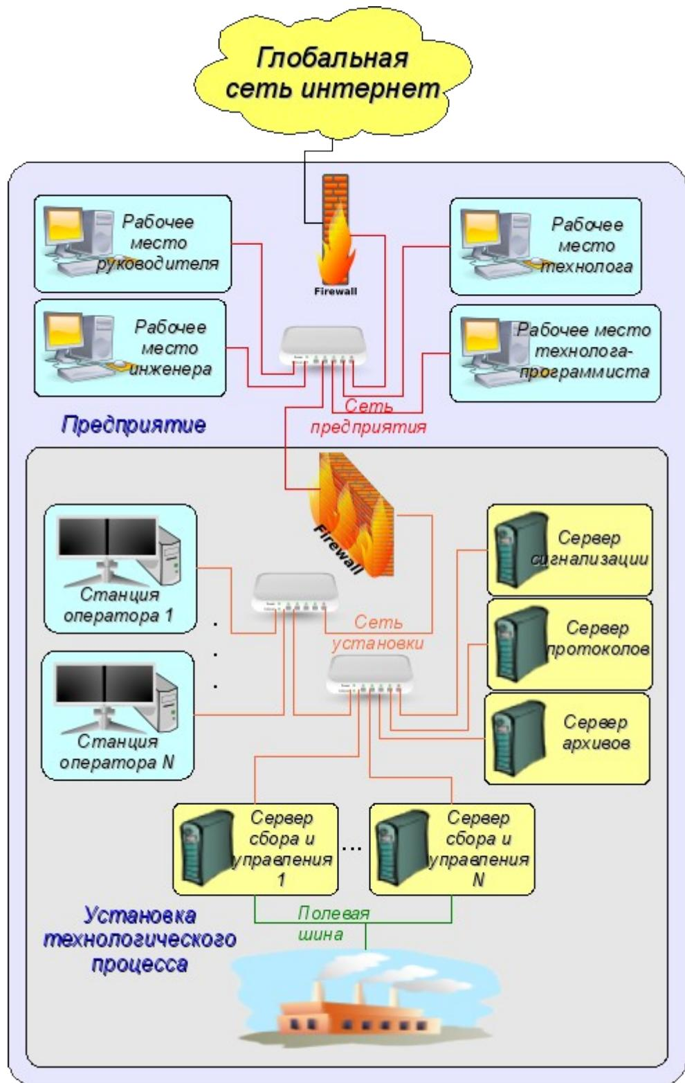
Рис. 2. SCADA-система.
