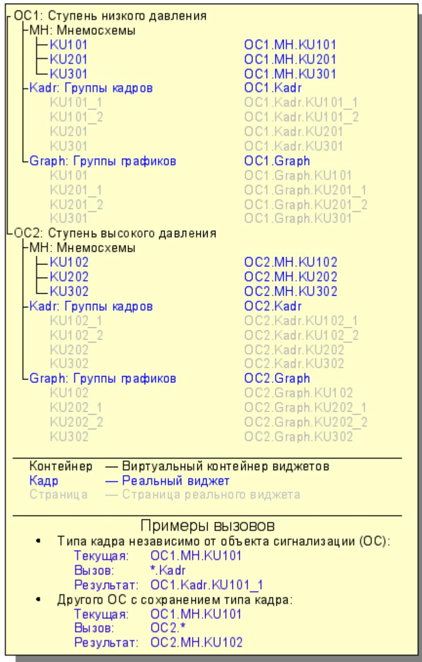
Рис.3.2 Иерархическое представления компонентов проекта классического интерфейса ВУ технологического процесса.
