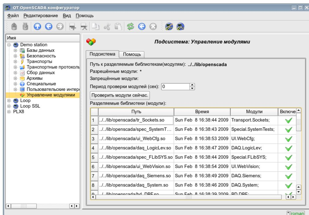
Рис. 4.9а. Главная вкладка конфигурации подсистемы "Управление модулями".
