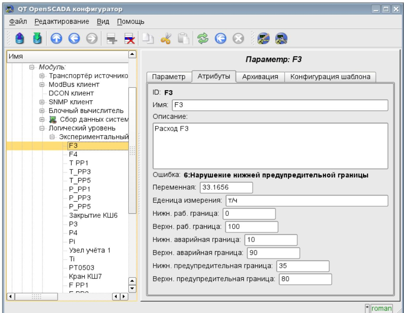
Рис. 11. Вкладка "Атрибуты" параметра "F3" модуля логического уровня.
