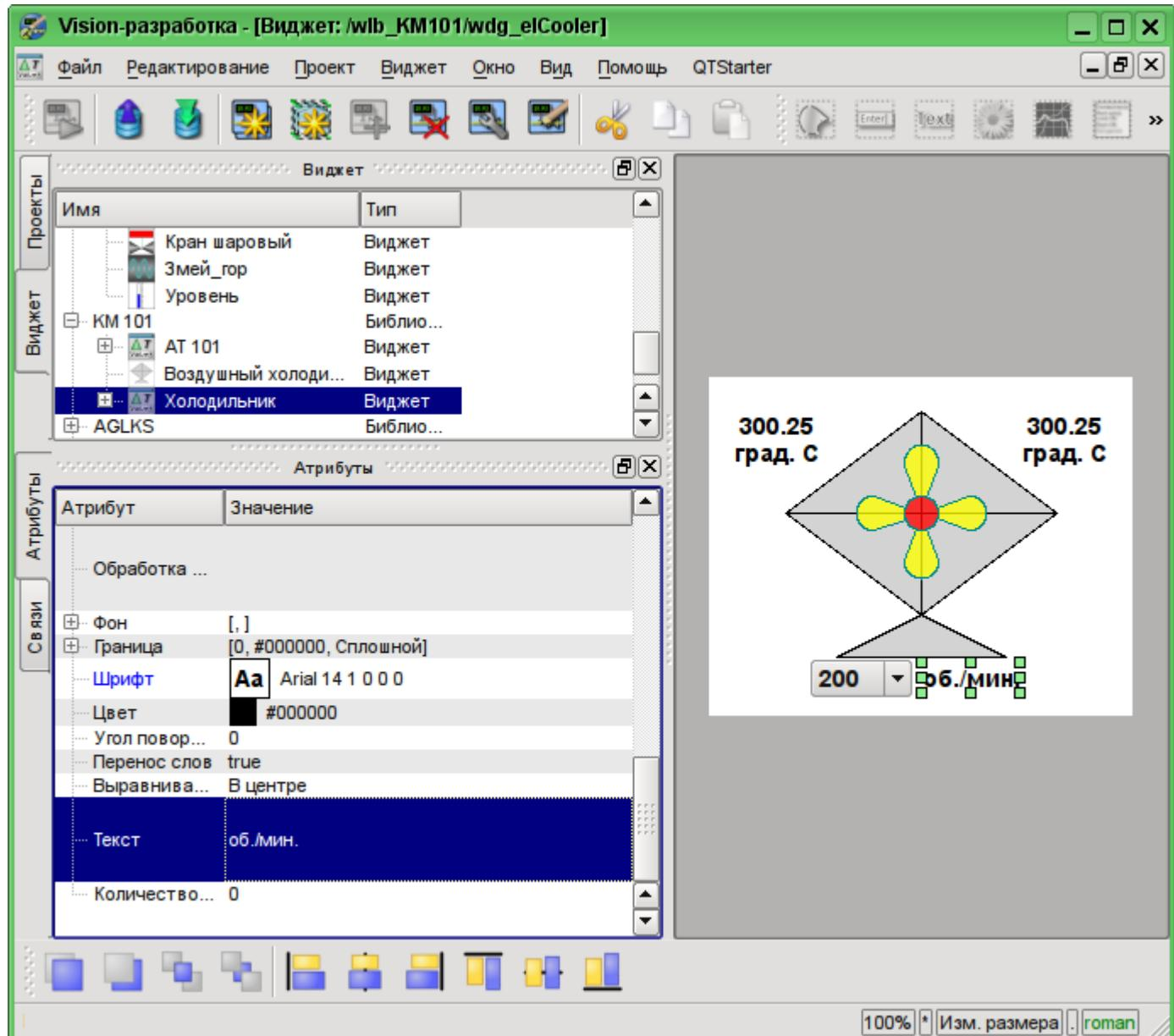
Рис. 5.3.2.15. Добавление виджета "dimension", основанного на примитиве "Текст" и изменение его параметров.
