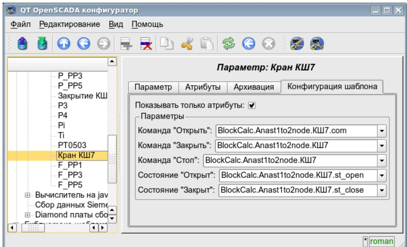
Рис.4. Вкладка конфигурации шаблона параметра. Показывать только атрибуты
