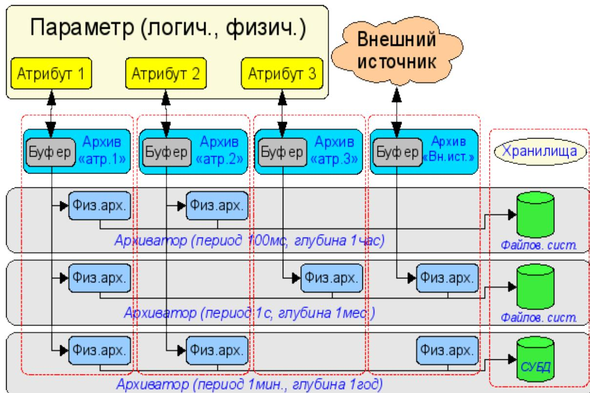
Рис.2. Общая схема процесса архивирования значений модуля FSArch.
