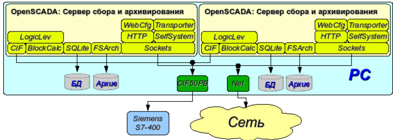
Рис. 3.3. Дублированное серверное подключение на одном сервере.
