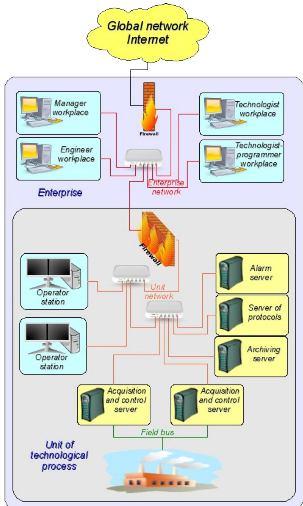
Fig. 2. SCADA-system.
