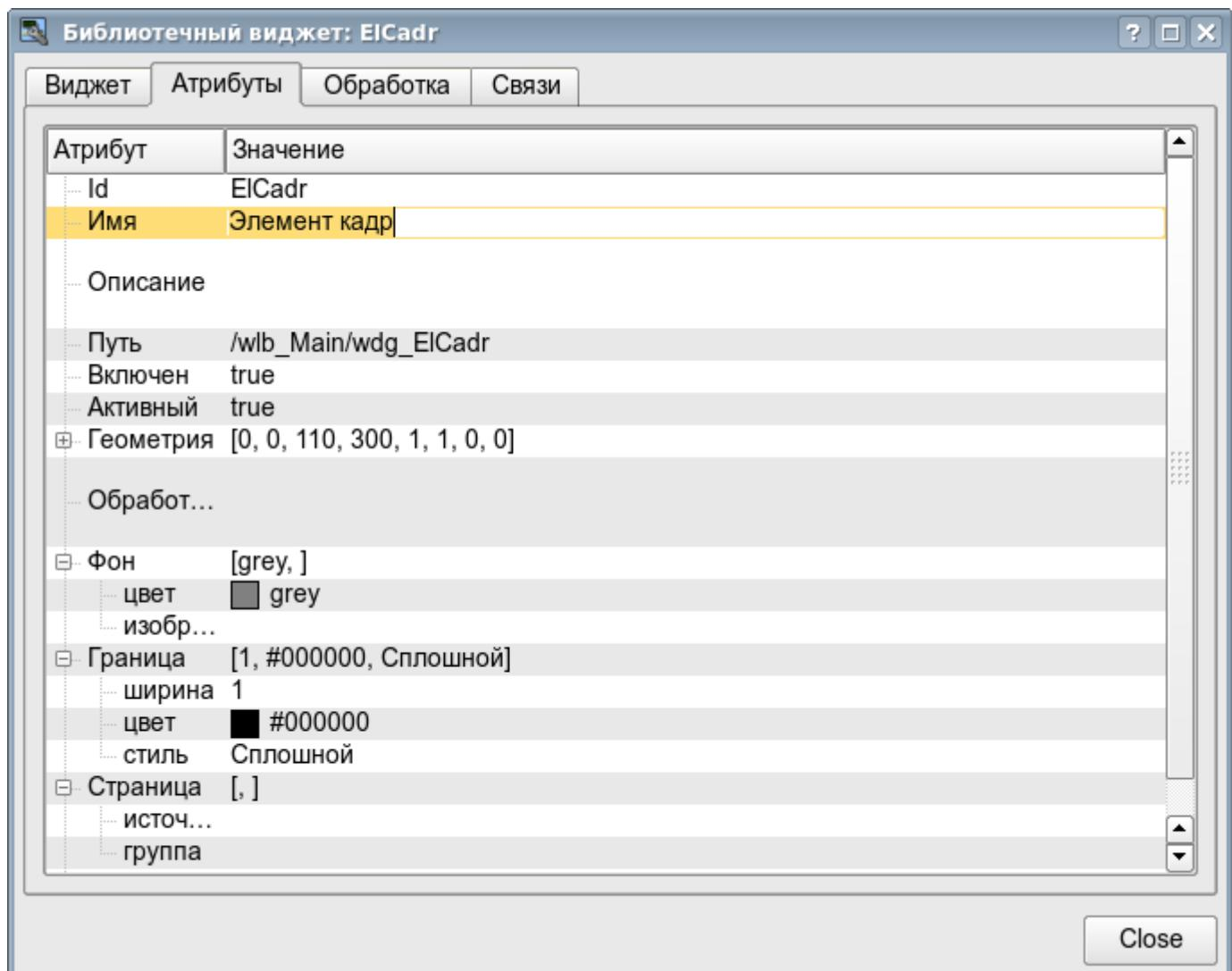
Рис.5. Вкладка атрибутов диалога редактирования свойств визуального элемента.
