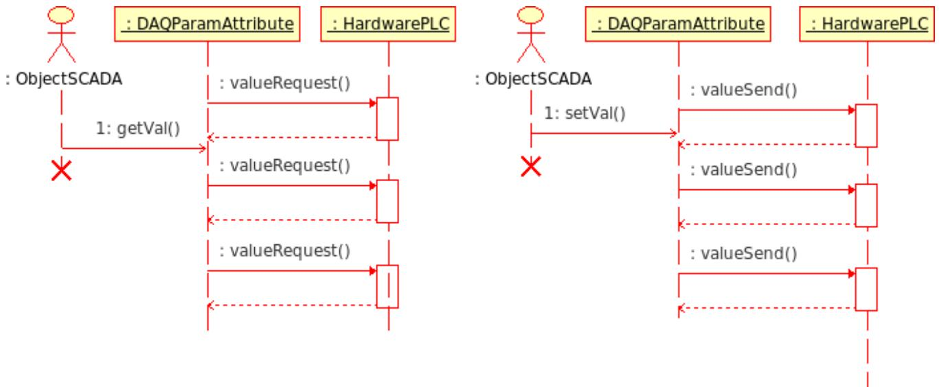
Рис. 3. Диаграмма последовательности взаимодействия при асинхронных запросах.
