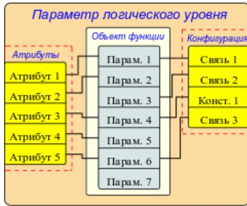
Рис. 8. Структура параметров, с шаблоном в основе.
