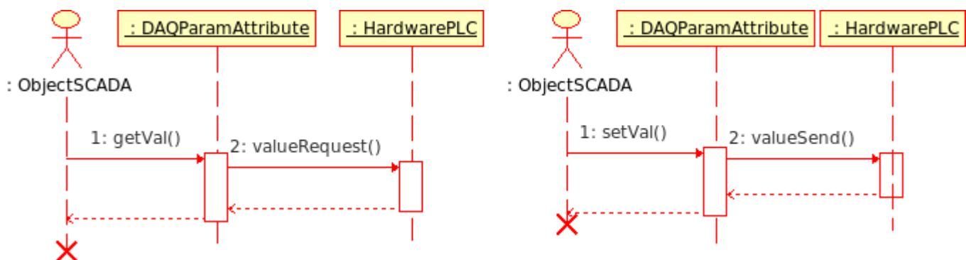
Рис. 2. Диаграмма последовательности взаимодействия при синхронных запросах.
