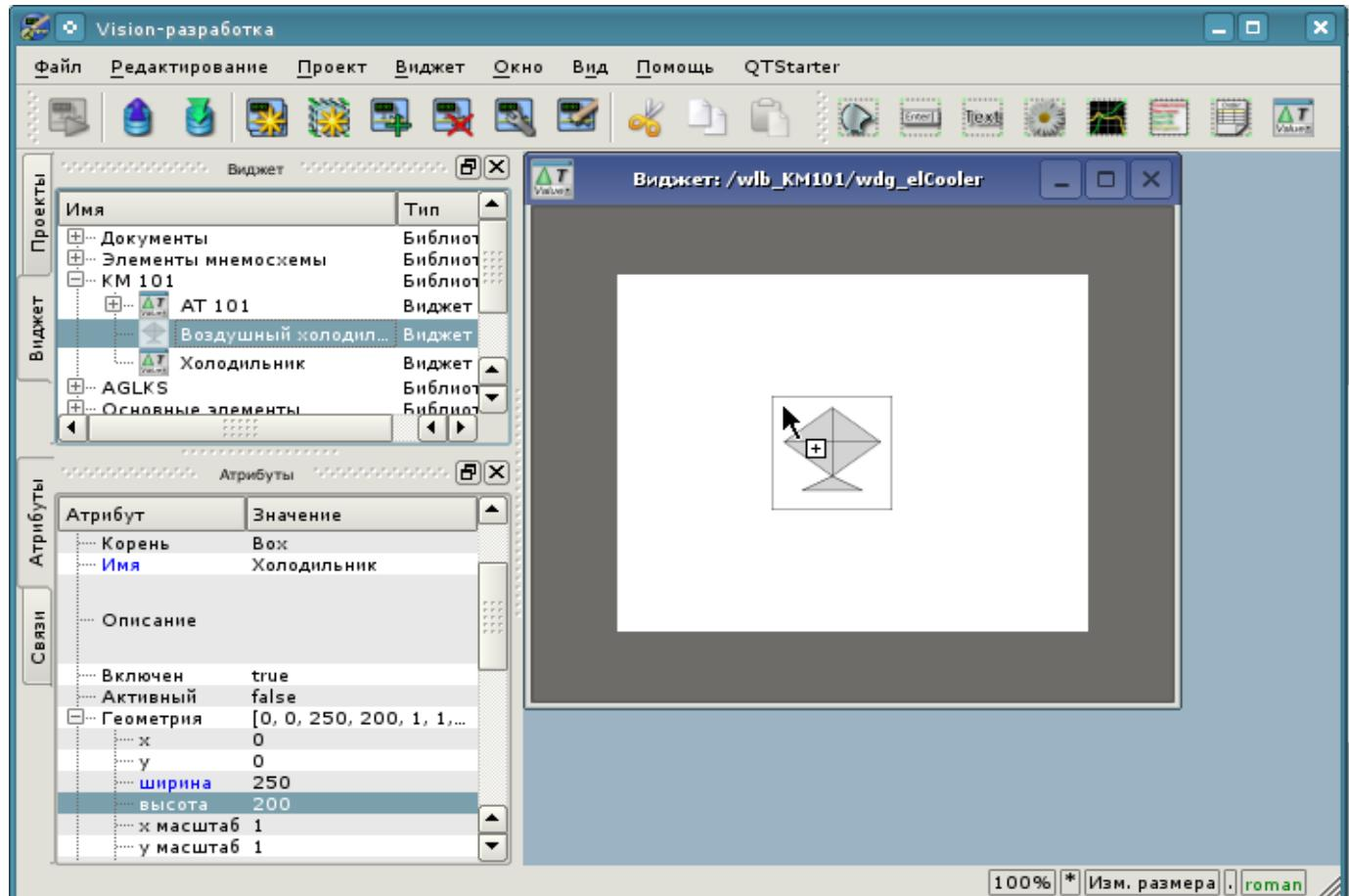
Рис. 5.3.2.2. Перетаскивание( Drag&Drop ) виджета "air\_cooler" в виджет-контейнер "elCooler".
