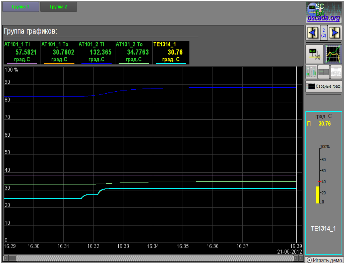
Рис. 5.1.6. Созданная группа графиков с четырьмя подключенными сигналами и одним типизированным параметром.
