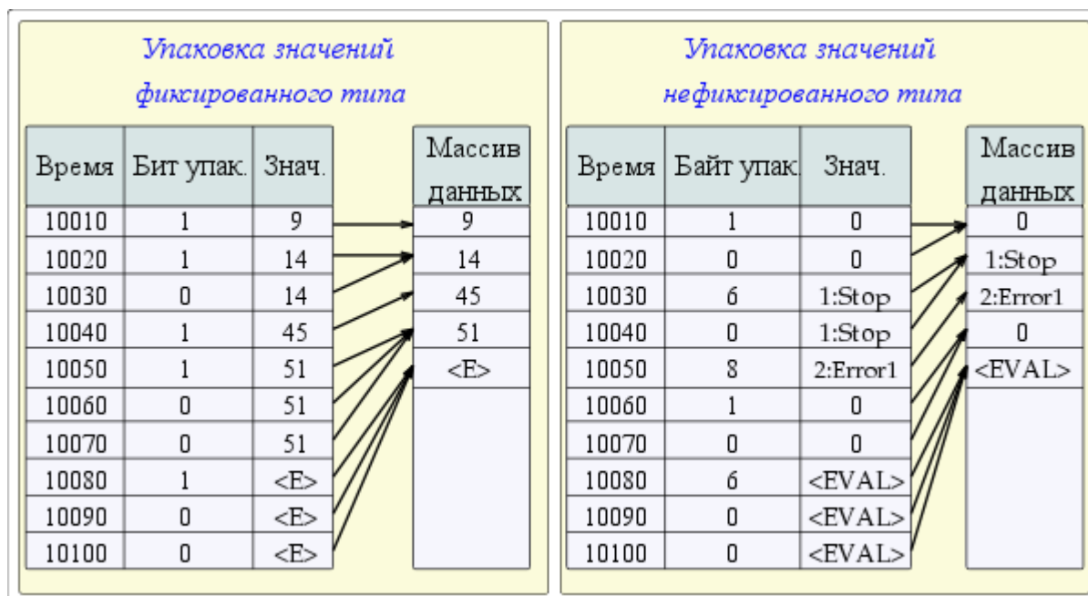
Рис. 5. Механизм последовательной упаковки значений.
